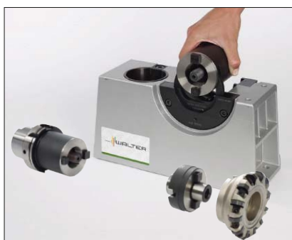
5. Einlegen der Verlängerung in die Steckscheibe.
