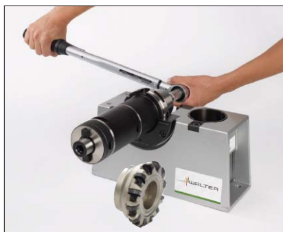
10. Festsziehen mit einem Drehmomentschlüssel.
