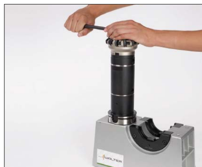
12. Einbau und Festsziehen des Werkzeuges.
