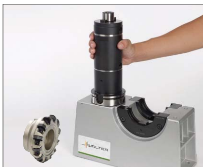
11. Einlegen der zusammengebauten Werkzeugaufnahme in den Steilkegel.
