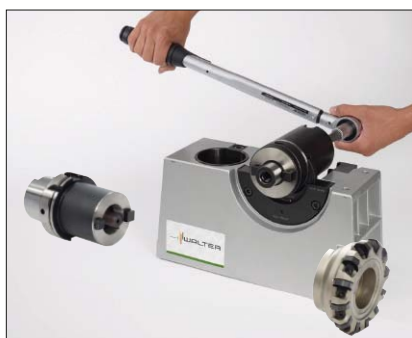
7. Festsziehen mit einem Drehmomentschlüssel.
