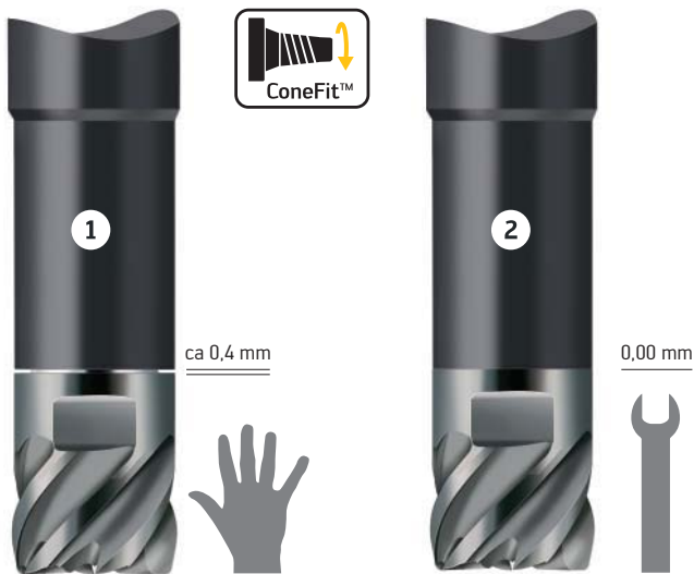
Drehmomente zum Montieren der Fräsköpfe
