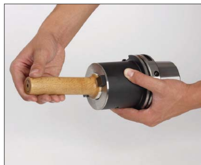
3. Reinigen des Innenkegels und der Plananlage.
