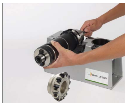
9. Zusammenschrauben der NC-Tool-Elemente mit dem Master.
