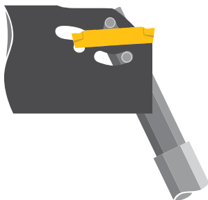
4. Neuen Schneideinsatz einsetzen
