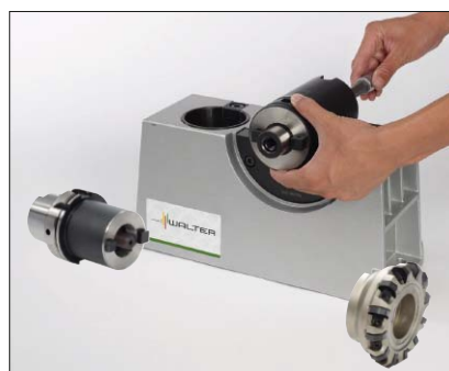
6. Zusammenschrauben der Verlängerung und der Fräseraufnahme mittels Steckschlüssel von Hand.
