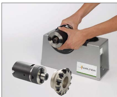
8. Einlegen des Masters in den dazugehörigen Flansch.
